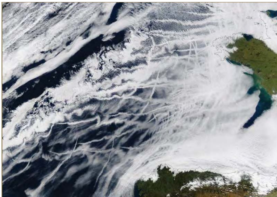
图 6 法国和西班牙海岸轮船排放（轮船尾气）在海洋与对流层的空白区域发现。这张图片，于 2003 年 11 月 27 日从 MODIS 卫星拍摄的，轮船尾气较多的一天。然而，轮船尾气代表了一个气溶胶-云相互作用的实例，目前还不清楚认为气溶胶是否在全球尺度上造成了云辐射强迫的气候变化意义。
